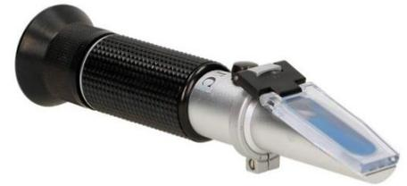
Este set de medición contiene además del refractómetro, una pipeta para la muestra de agua, un envase para líquido de referencia y un destornillador para la calibración. El método óptico para obtención de la salinidad es el más rápido, sencillo, cómodo y preciso de todos, teniendo en cuenta que además no necesita corriente eléctrica y es muy fácil de calibrar y mantener.
