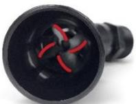
Los eductores con efecto "Vortex" BLEV están dotados de una turbina estática con 4 palas que provoca un comportamiento cónico-espiral en el flujo del agua. Entrega un menor alcance longitudinal, sin embargo un flujo muy suave homogéneo
