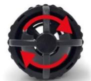
Los difusores con efecto Rotatorio "Nano" BLEN poseen una cámara rotatoria pasiva para provocar una corriente con sentido circular en el acuario. Su cámara interior gira constantemente aprovechando la energía cinética del agua que produce el flujo de la bomba para crear un flujo circulatorio y optimizar la eficiencia energética. Son articulables mediante 1 rótula móvil.
