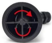
Los eductores con efecto Rotatorio BLER cuentan con cámara rotatoria pasiva para provocar una corriente circulatoria en el acuario. Este diseño ofrece menos alcance longitudinal que en el efecto "vortex", sin embargo su cámara rotatoria recorrerá un círculo de mayor diámetro sumado al flujo cónico de corriente. Son articulables mediante 3 rótulas móviles.
