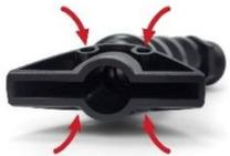
Los eductores "Pico de Pato" BLEPP están dotados de una "boca" aplanada que multiplica varias veces la velocidad del flujo de salida. Cuenta con 4 orificios para aspirar agua del acuario para sumarla al flujo de salida de agua de la bomba para obtener un eficiente efecto de educación.
