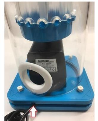
9. - **Conexión de la entrada de agua.** Sujete con ambas manos el cuerpo del espumador e inserte el conector sobre la conexión de entrada de agua de la bomba. Esta conexión debe encajar correctamente.
