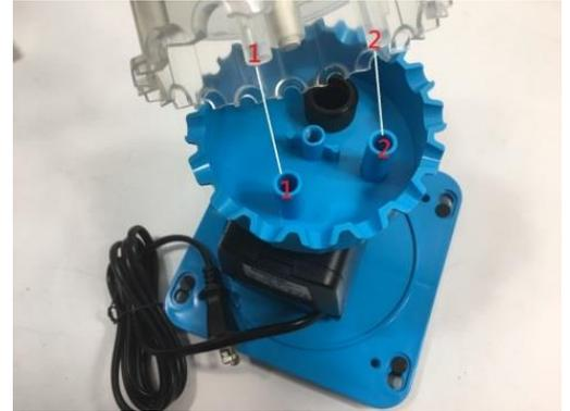
7.- **Bandeja difusora.** Ajuste la bandeja difusora firmemente sobre la bomba y revise de nuevo que el cable de la bomba queda colocado en la posición correcta.
