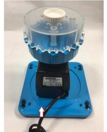
8. - **Montaje del cuerpo.** Coloque el cuerpo sobre la base y revise la posición del cable de forma que asome por la ranura del cuerpo de la bomba. Ahora apriete los cuatro tornillos que sujetan la base con el cuerpo.
