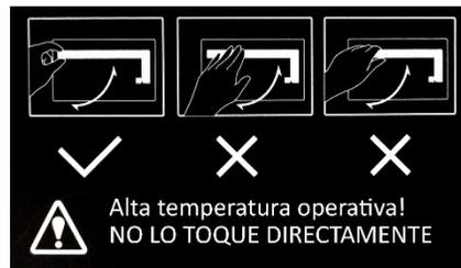
Mantenga una buena aireación alrededor de la luminaria y NO TOQUE directamente con las manos durante su funcionamiento. Para girarla de forma segura mientras está en funcionamiento, puede sujetarla de su extremo como se describe en la figura de la derecha. En caso de sufrir quemaduras leves lávese la superficie con agua fría y acuda a un médico.
