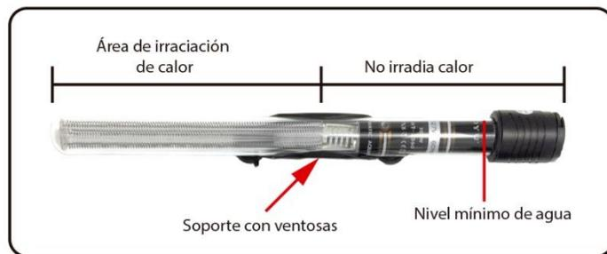
7. Por seguridad el soporte de ventosas debe colocarse en la parte superior del calentador (el área que no emite calor). Esto evitará que pueda deformarse a causa del calor emitido por su área de irradiación. Observe el gráfico de la derecha.
