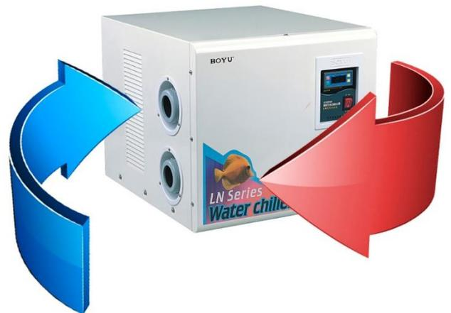
**Nunca instale una llave de paso de agua a la salida del enfriador.** Si por accidente interrumpiera la salida del agua del enfriador con la bomba de alimentación funcionando podría acumular presión excesiva en el evaporador, agrietándolo y provocando una fuga de agua. Esta avería no puede repararse, ya que su costo es superior al del aparato.
