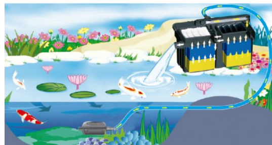
La orientación de la conexión de salida debe quedar por debajo del nivel máximo del filtro
