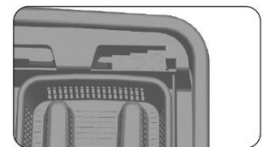
Coladera del filtro YT 45000
